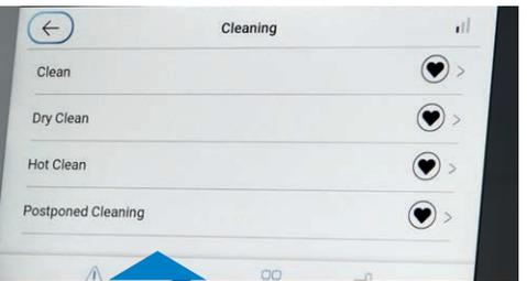
El programa de **limpieza diferida garantiza la seguridad higiénica** gracias al control de la temperatura del cilindro una vez extraído el gelato. Por tanto, no es necesario el lavado inmediato de la máquina en caso de paradas prolongadas del trabajo.
