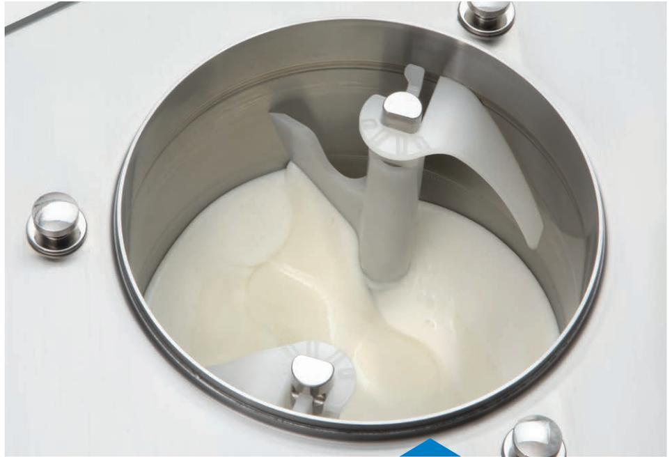
La **velocidad del agitador** puede modificarse en función del tipo de receta para mejorar la textura y la estructura finales.
